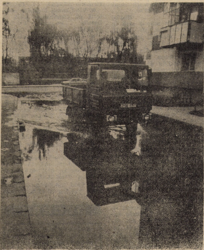
Cartierul Tineretului, cartier nou și frumos ridicat de cîțiva ani suferă din neglijența celor de la Drumuri și poduri care, au construit gurile canalelor pentru deversarea apei pluviale deasupra nivelului șoselei. Aproape pe fiecare străduță tro-nează cite o baltă dar cea pe care o prezentăm în imagine depășește orice inchipuire Foto: Andrei BUTA
