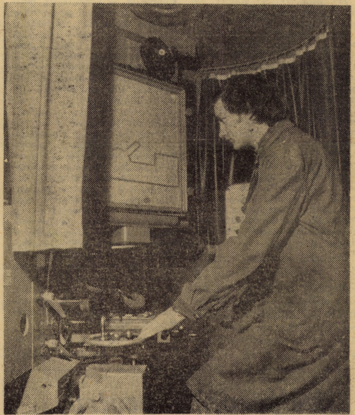
Cu ajutorul unei mașini de rectificat prin copiere cu citire optică — unul din cele mai perfecționate utilaje ale întreprinderii „Mecanica” Mediaș, rectificatorul Ioan Roth (în imagine) realizează prelucrarea pieselor la un înalt grad de precizie, în condițiile reducerii minime a efortului fizic. Foto: FR. NUSS
