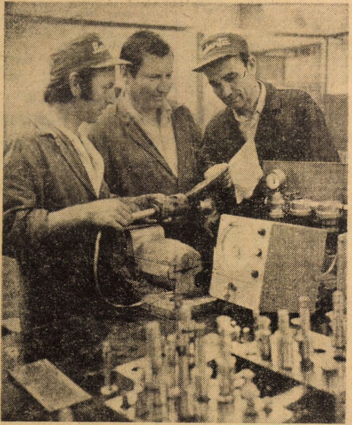
„Balanța II”. Măsurarea pieselor componente ale instalației hidraulice de comandă a mașinii de rectificat universal. În imagine: sub conducerea maistrului Nicolae Birsan se execută măsurarea abaterilor alezajelor; precizia măsurătorii este de ordinul micronilor
