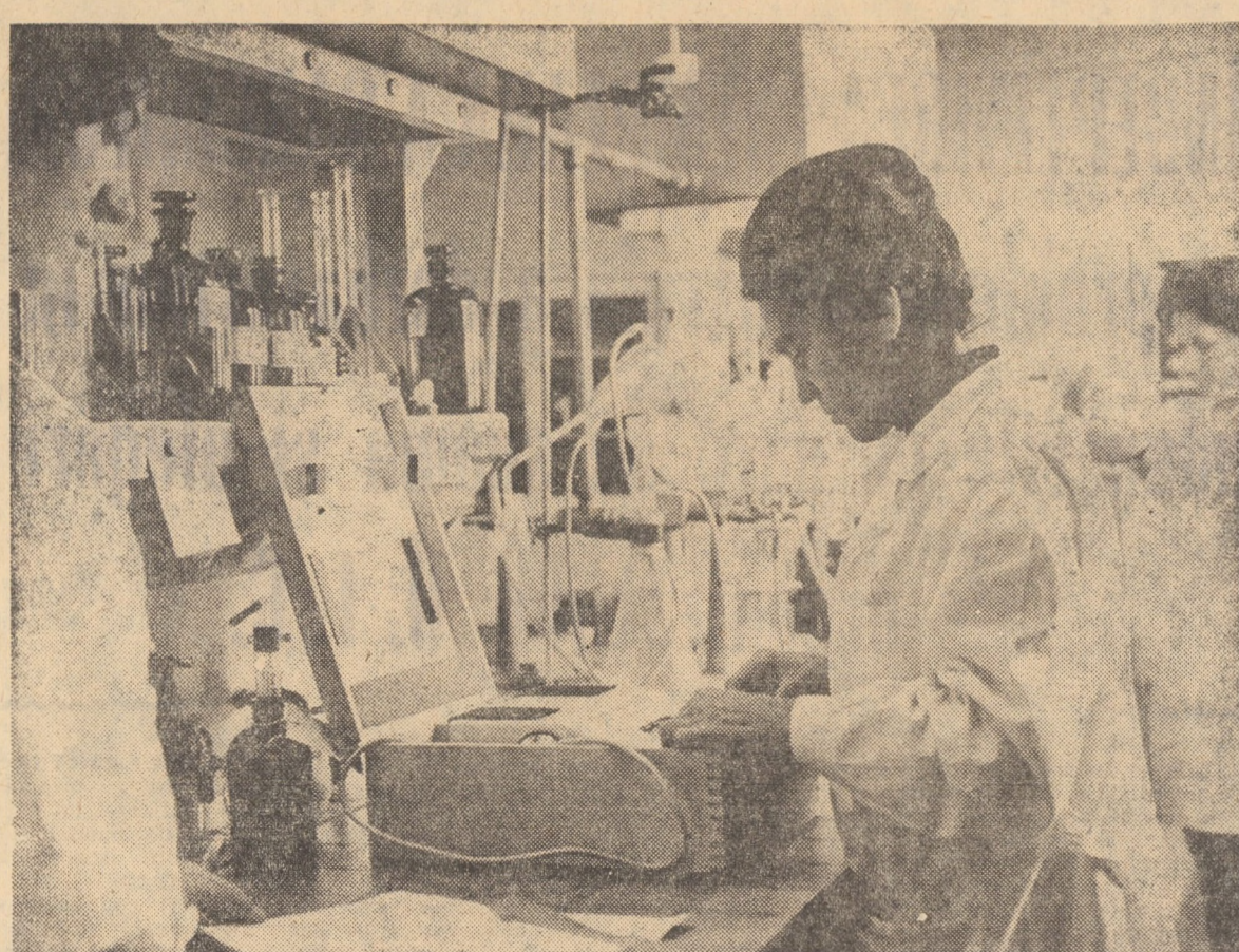
Măsurători de precizie, efectuate cu ajutorul fotocolorimetrelui — aparat pentru determinarea elementelor componente ale oțelurilor folosite la fabricarea diferitelor accesorii textile — în laboratorul chimic al întreprinderii „Flamura roșie” Sibiu
