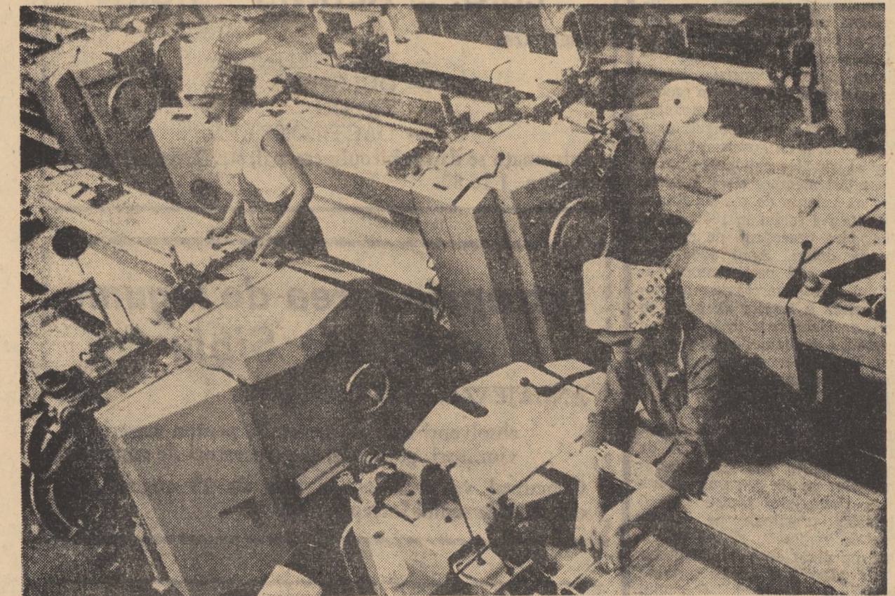
Cele 50 de războaie automate pneumatice fără suveică, instalate de curînd la fabrica „Tirnavă” Mediaș, se află în probe tehnologice. Noile utilaje funcționează cu 300 ture/minut și dispun de o lățime de lucru de 120 cm
